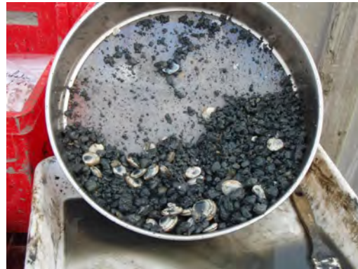
Figure 4. Tamisage des échantillons à bord à l'aide de la manche à eau du bateau. Refus de tamis de maille 1 mm qui sera conservé dans du formol à 5%.
