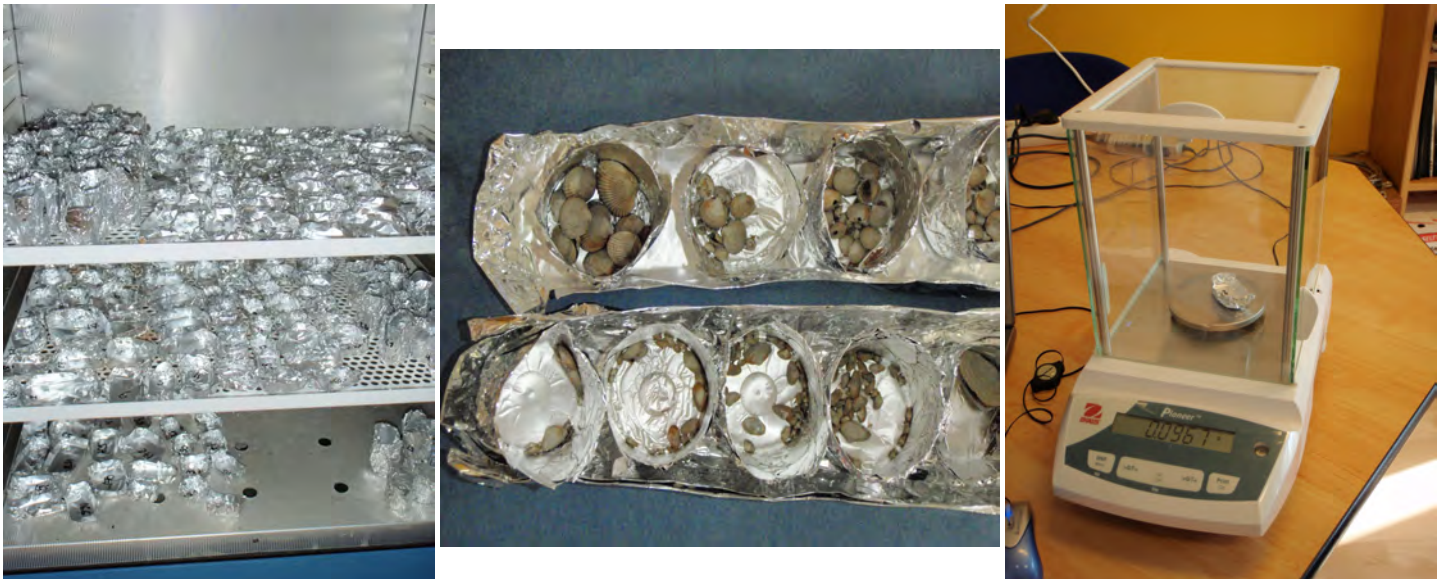
Figure 6. Mesure de la biomasse des organismes benthiques. Séchage en étuve à 60°C puis pesée avant ignition à 450 °C pendant 4h.
