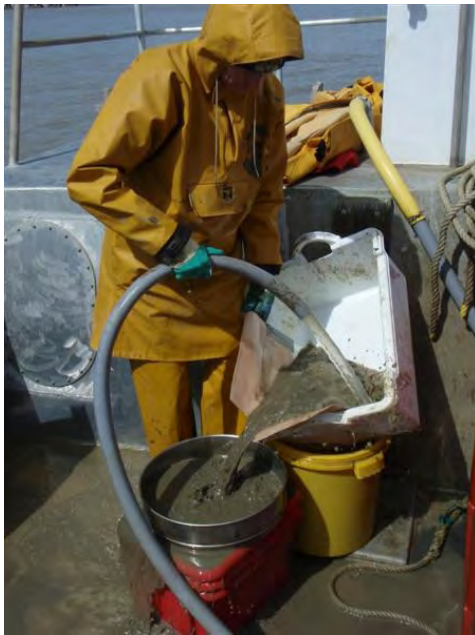
Figure 4. Tamisage des échantillons à bord à l'aide de la manche à eau du bateau. Refus de tamis de maille 1 mm qui sera conservé dans du formol à 5%.
